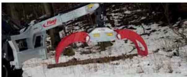
Grappin hydraulique LongNeck Combi Plus avec rotateur à l'infini
