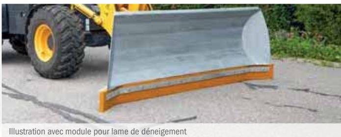
Illustration avec module pour lame de déneigement
