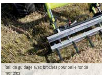
Rail de guidage avec broches pour balle ronde montées
