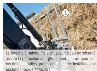
La fourche à palette Freisicht avec arceau de sécurité assure la protection anti-glissement, par ex. pour les tas de bois, balles, profils en acier, etc. Installation a posteriori rapide et facile !
