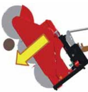
Coupe de branches épaisses jusqu'à 280 mm de diamètre.
