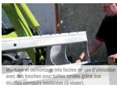
Montage et démontage très faciles en cas d'utilisation avec des broches pour balles rondes grâce aux douilles coniques existantes (à visser).
