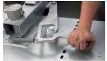
Tête pivotante mécanique (30° à gauche et à droite)
