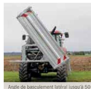
Le centre de rotation se trouve loin devant (angle de basculement latéral jusqu'à 50°, angle de basculement arrière jusqu'à 55°), ce qui permet de déverser les matières d'une hauteur plus élevée des 3 côtés
