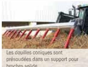
Les douilles coniques sont présoudées dans un support pour broches solide
