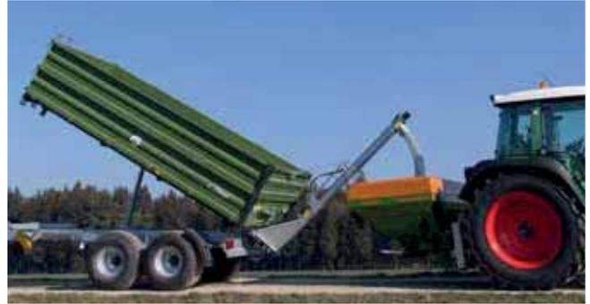
La vis de transbordement peut être fixée très facilement à toute sorte de remorque basculante. Le maniement s'effectue facilement. Réglage en continu de l'angle de déversement par un treuil à câble.
