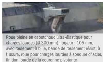
Roue pleine en caoutchouc ultra-élastique pour charges lourdes (Ø 300 mm), largeur : 105 mm, avec roulement à bille, bande de roulement résist. à l'usure, roue pour charges lourdes à soudure d'acier, finition lourde de la couronne pivotante
