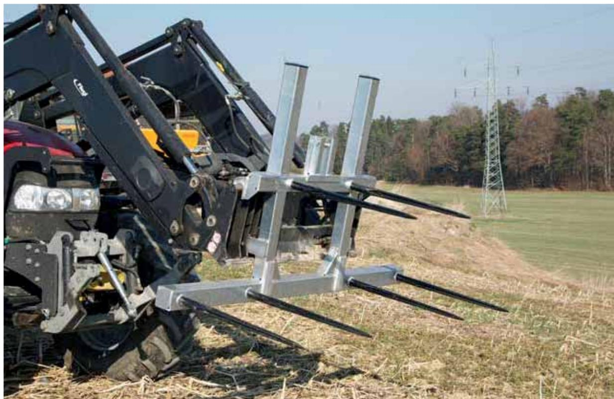
Illustration : pique botte à fond poussant avec dispositif de surélévation et six broches pour balles rondes (2 broches - supplément)
