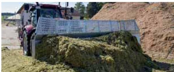
Grillage supplémentaire : surélévation (400 mm) sur toute la largeur de travail de la lame de nivellement. Le dispositif de surélévation est tout simplement vissé sur la lame de nivellement.
