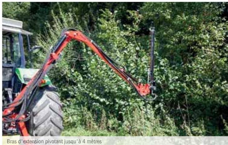
Bras d'extension pivotant jusqu'à 4 mètres
