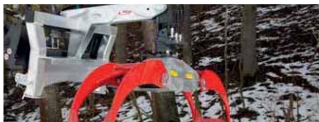
Grappin hydraulique Combi Plus RZ 185 avec rotateur à l'infini
