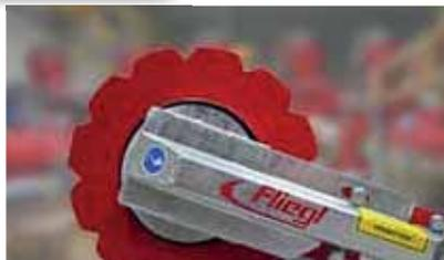
Couvercle de protection du moteur hydraulique
