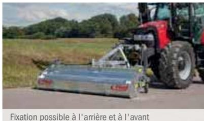
Fixation possible à l'arrière et à l'avant
