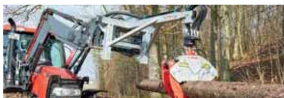
Illustration avec rallonge pour crochet de suspension (normes européennes), moteur couple avec pince de transbordement
