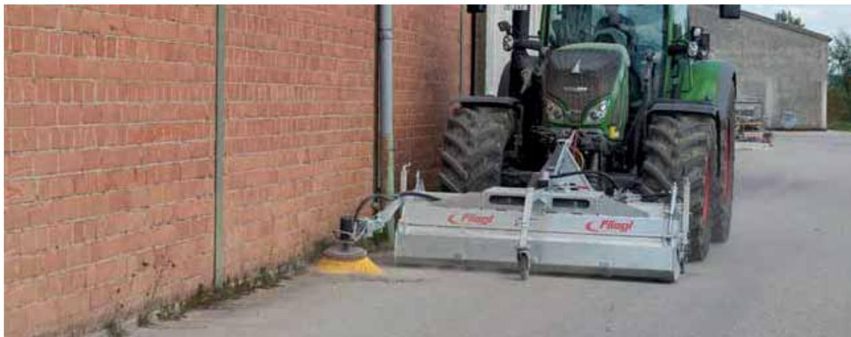
KEH Type 500 avec attelage trois points, cuve de collecte des déchets hydraulique, balai latéral et roue porteuse avant
